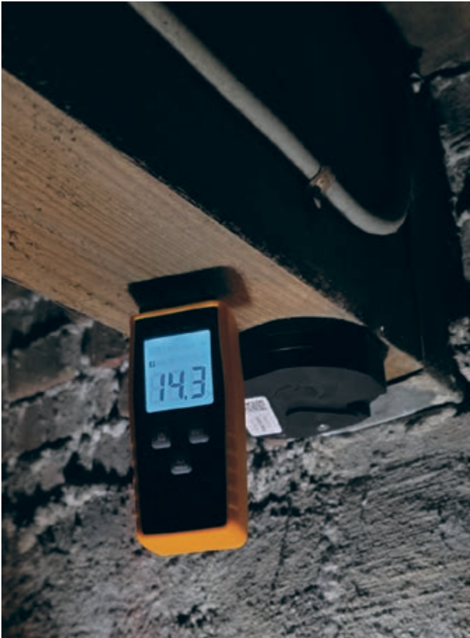
In twee balkkoppen en enkele vloerbalken zijn meetpunten aangebracht om op afstand het vochtgehalte te monitoren. De foto's zijn gemaakt op het moment dat de balken voldoende droog waren om met de isolatiewerkzaamheden te kunnen beginnen.
