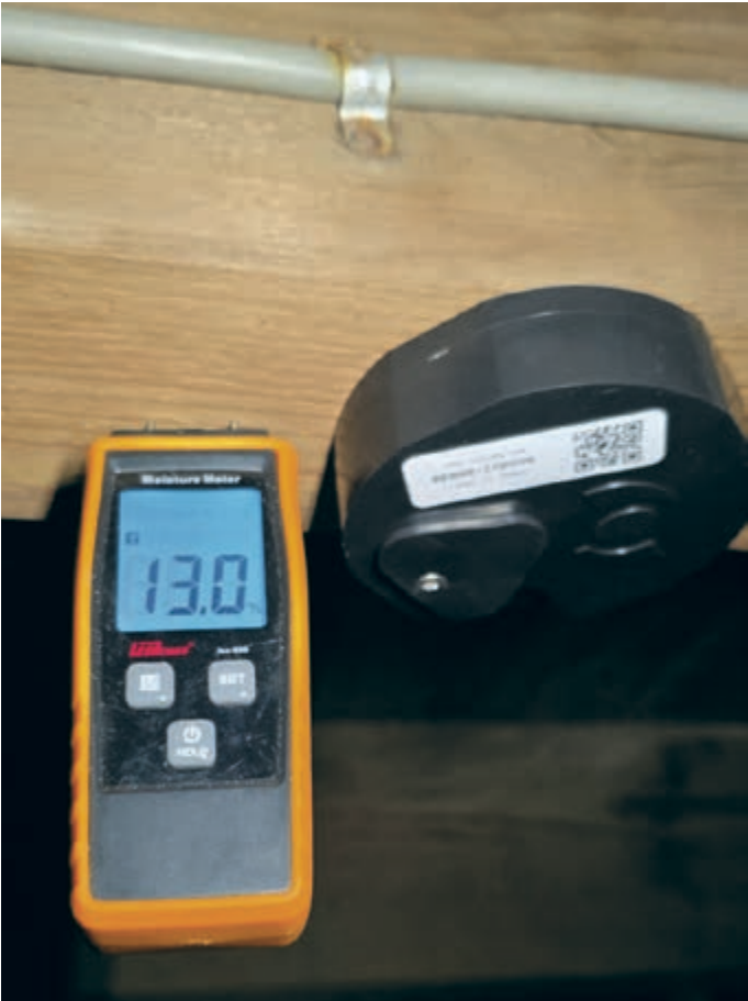
In twee balkkoppen en enkele vloerbalken zijn meetpunten aangebracht om op afstand het vochtgehalte te monitoren. De foto's zijn gemaakt op het moment dat de balken voldoende droog waren om met de isolatiewerkzaamheden te kunnen beginnen.
