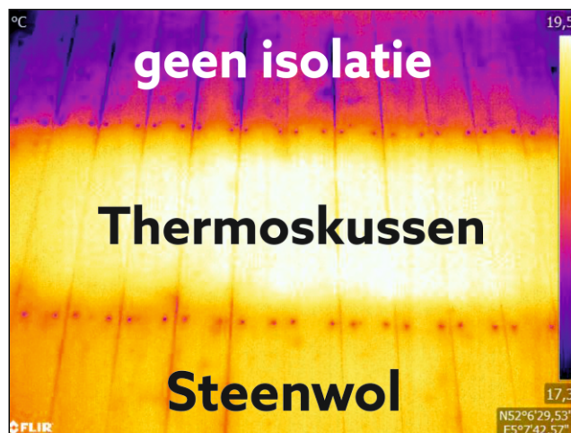
verschil in isolatiewaarde veroorzaakt altijd temperatuurverschil ongeacht de mate van verwarmen
